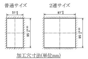
(注)( )内寸法は、石膏ボード用 はさみ金具を使用の場合を 表します。
