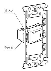
(2) マイナスドライバーを取付枠『右側』かしめ穴部に差込み、取付枠の突起部を器具の差込穴にかしめる様に回転させる。
