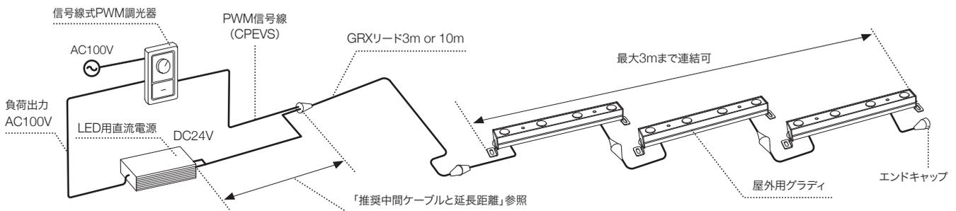
屋外用グラディは絶縁・防水処理を確実にし、作業を簡易化するためにコネクタ配線タイプへ仕様変更を行いました。電源との接続にはGRXリード3mまたはGRXリード10mが必要です。10m以上延長するにはGRXリード3mにVCT2sq電線を接続して延長してください。灯具間を離して設置するための中間延長コネクタもごさい。詳しくはお問い合わせください。
