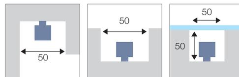
50mm幅の溝に設置することが可能です。意外に余裕のない建築ファサードのスペースや、極力目立たせたくない施工条件でもお使いいただけます。また密閉環境での使用も可能です。
