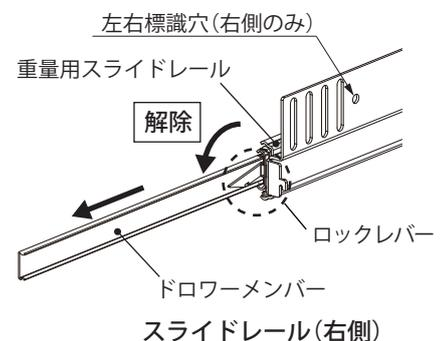
②ドロワーメンバーを重量用台板に付属のバインド小ねじ M4 で固定してください。
