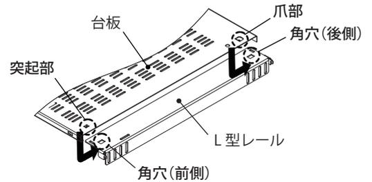
②台板の突起部と L 型レールの角穴(前側)の位置が合うように、台板を置いてください。
