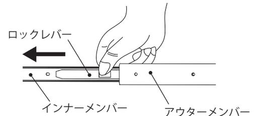
②山型レールにはアウターメンバー、スリット付スライド台板にはインナーメンバーを、各々付属のバインド小ねじ M4 で固定してください。
