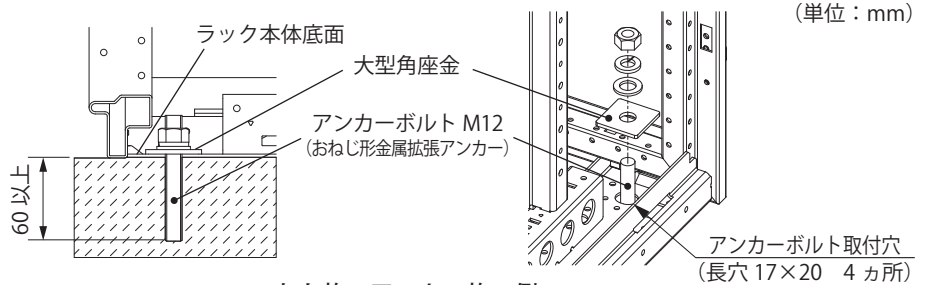
あと施工アンカー施工例
