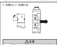
切替カバーの中央にあるへこみを利用して開けて ください。別の部位からあけますと指の損傷、切替 カバーが外れるおそれがあります。
