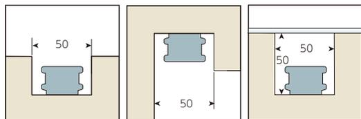
※図の数値は熱による影響から定めた安全にお使いいただける最小施工寸法(単位mm)です。実際の施工では、光の効果やメンテナンス性を考慮し、より広い開口寸法をおすすめします。
