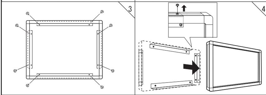
正面より壁面取付アングルの穴から直付け用ビスを取り付けます。
