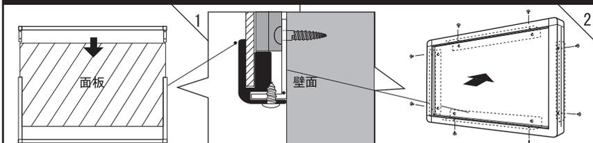
取り外したフレームの長手を外し、面板等の中身を全てフレームに戻します。
