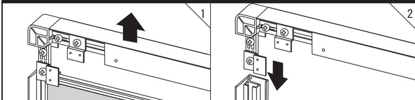
プラスドライバーでコーナーのビスをゆるめ、長手一辺を抜いて、中身を出します。
