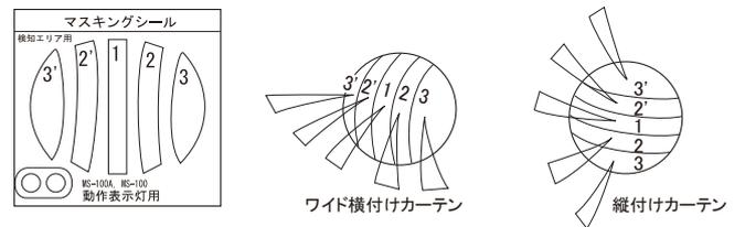
⚠ 縦付けカーテンエリアを屋外で使用する場合は、水平より上側の2エリアを下記に従ってマスキングしてください。レンズのロックツメ切断後、2°、4°、6°の上下調整を行ってください。
