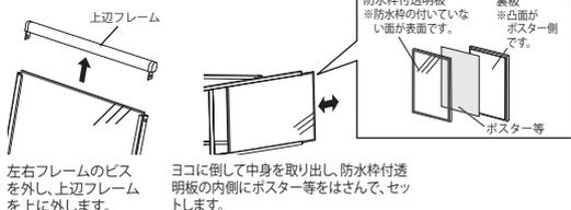
左右フレームのビスを外し、上辺フレームを上を外します。
