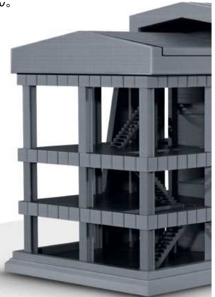
インベンチュアを使用して一体出力した物 (サポート除去後)
