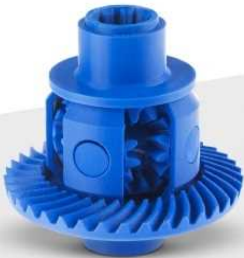
ディファレンシャルギアの可動モデル 水溶性サポート材を使用すると、可動メカニズムを一度に出力することができます。
