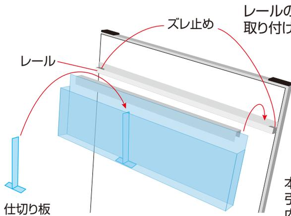
レールの左右には、ケース落下防止用のスレ止めを取り付けています。
