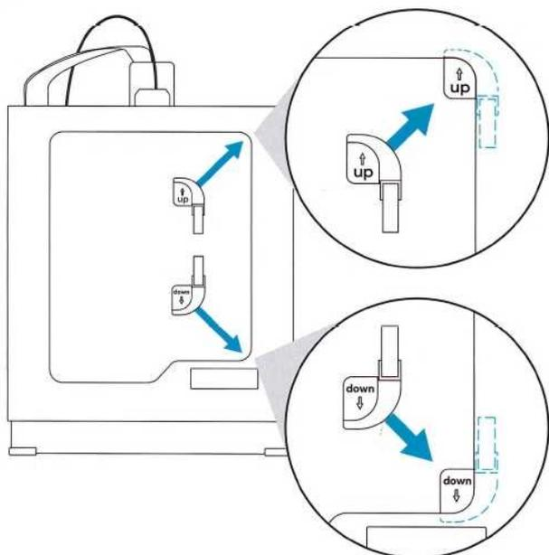
M200の正面開口部分の縁に治具を合わせてマグネットを貼り付けます。
