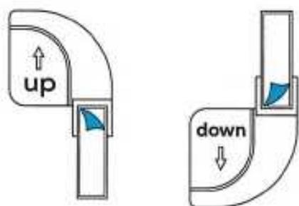
図を参考にして取付け治具にマグネットを挿しこみます。
