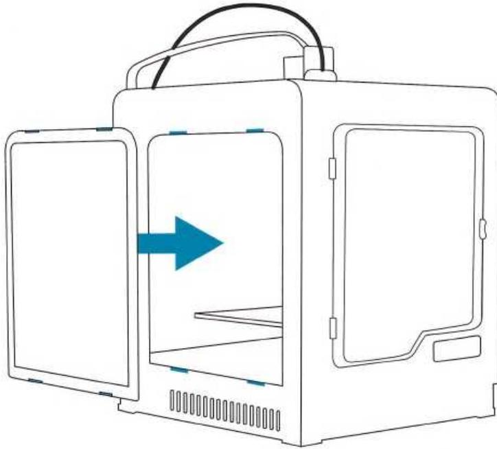
左右のパネルは下側を先に引掛けて上を押し込みます。
