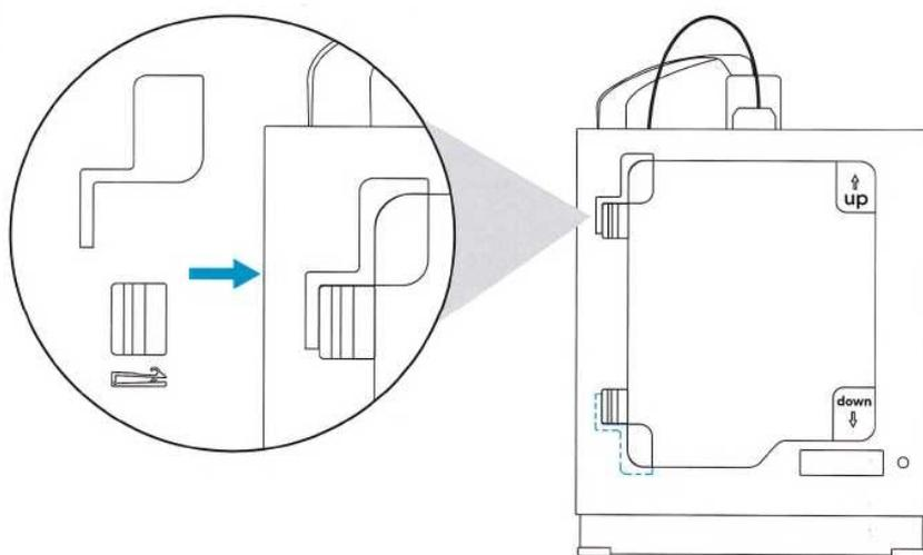
M200の正面開口部分の縁に治具をを合わせて、ヒンジ部品を挿しこみます。
