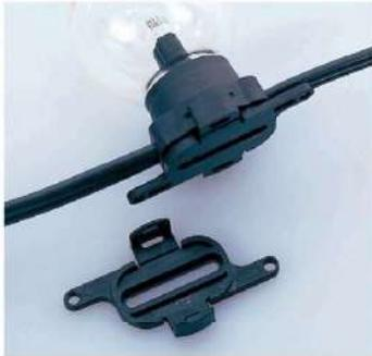
取付アダプタはネジ止め固定用のオプションパーツです。アダプタを器具にはめこみ、市販のΦ3.5～4mmネジで固定します。
