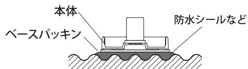
取付面に凸凹がある場合は、防水性能を保つため、防水シールなどで器具と取付面とのすき間を埋めてください。
