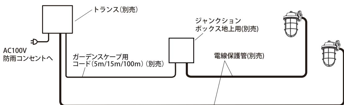
※地中配線の場合は、ライトの電源コードを電線保護管(別売)に必ず通し、
