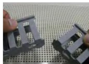
通線孔の上記をダクトカッターDC-1(47頁)等でカットし、そのまま曲げて長さ方向に折り取ることができます。
