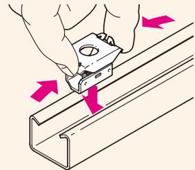
②ナット部がダクター内に入ったのち、右に回転させて所定位置に仮り止めます。
