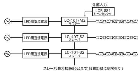
スレーバ最大接続50台まで(設置距離に制限有り)
