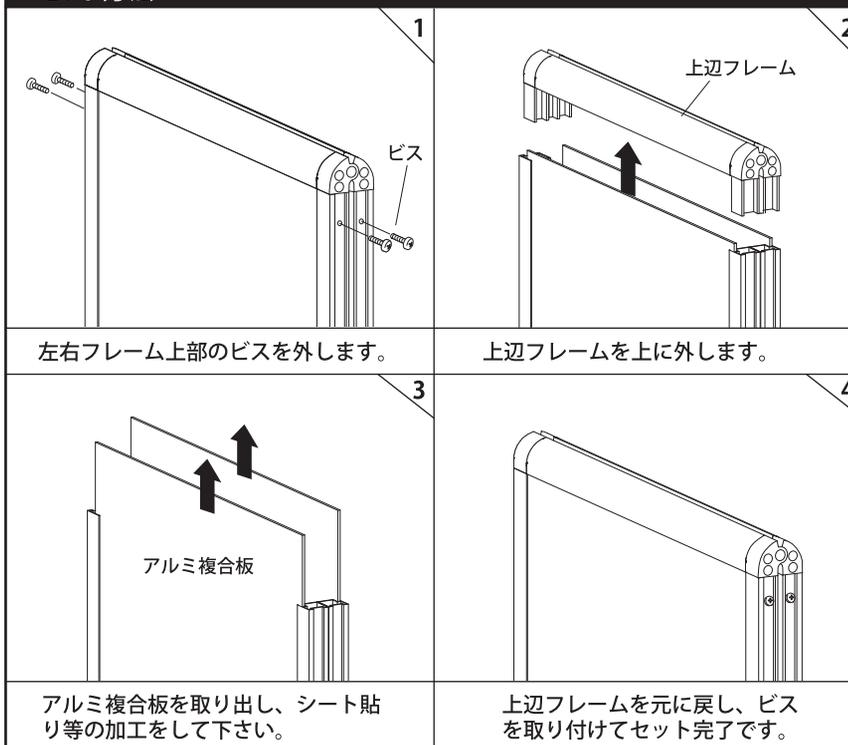
左右フレーム上部のビスを外します。
