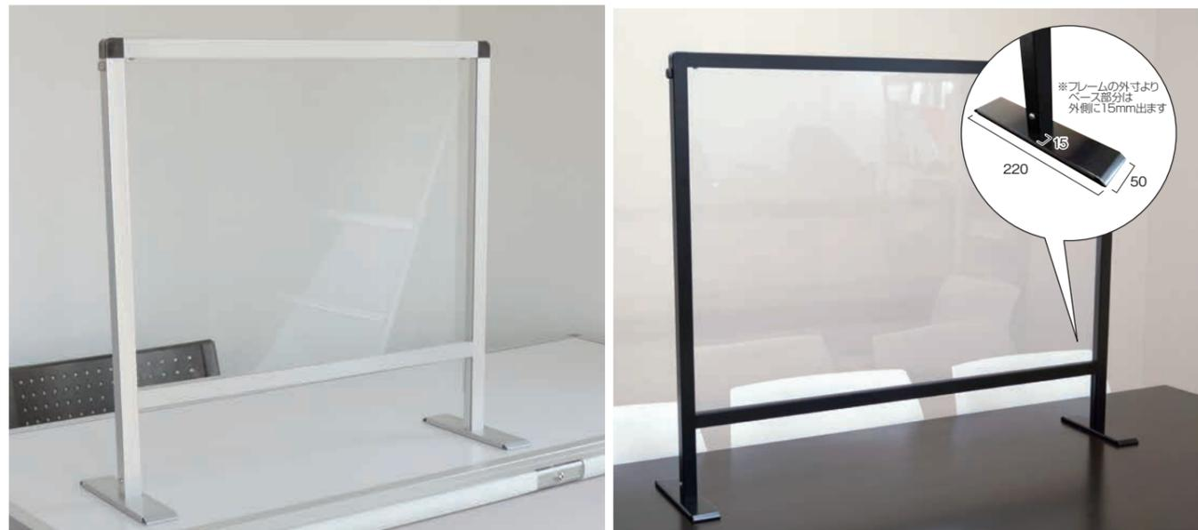
●パネルフレーム=22mm×25mmアルミ押し出し材/アルマイト仕上げ(シルバー/ブラック) ●アクリル板/塩ビ板(透明)=厚さ1.5mm~1.8mm
