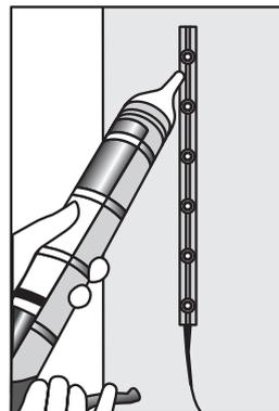
施工面にネジや釘が有効でない場合はシリコン系または塩ビ系接着剤の併用を推奨します。
