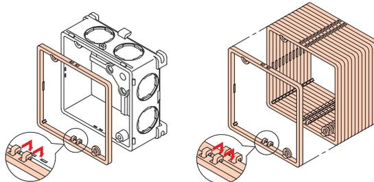
ご注意:当社ワンタッチ式塗代カバー類にボックス継枠を使用する場合は全てねじで固定してください。
