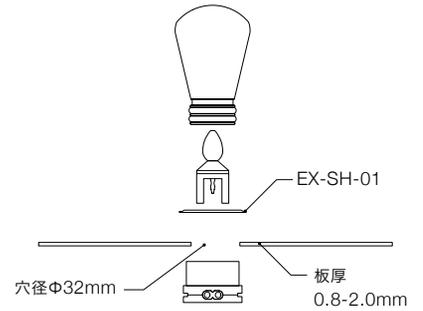
ソケットホルダは、圧入式の固定パーツです。パネルにΦ32mmの穴を設け、ソケットを固定します。
