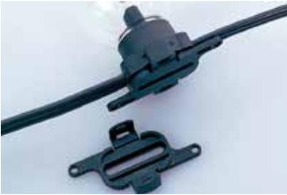
取付アダプタはネジ止め固定用のオプションパーツです。アダプタを器具にはめこみ、市販のΦ3.5～4mmネジで固定します。
