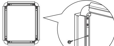
フレームを開き、取付穴よりビス止めします。
