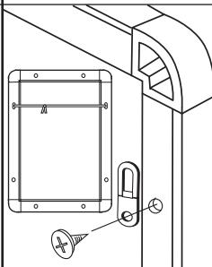
フレーム裏側の穴に吊り金具を取り付けて、ひも等で吊り下げます。
