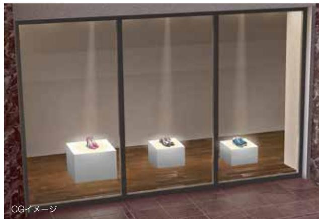
緻密なリフレクタ設計で光学的に配光を制御しています。マルチシャドウのない超狭角配光の光で、照らしたいものだけを照らすことができます。
