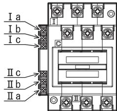
■KSS-62-CH, KSS-63-CH 【補助接点（無電圧c接点）】
