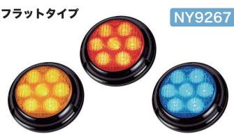
パワー LED を 7 個使用し保護特性 IP67 のフラッシュライトです。フ ラットタイプで車両や設備機器に使用します。発光面が平面のため非 常に明るく点滅します。連結して最大 8 台まで同期点滅でき、点滅パ ターンは26あります。
