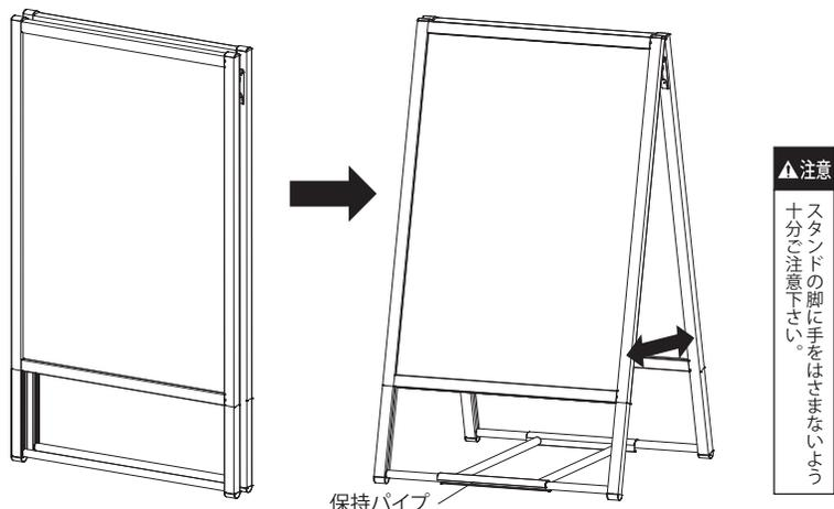
スタンドの脚を開いて立たせ、保持パイプを脚下部のバーにセットします。
