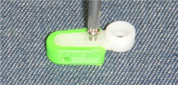
4-3 微調整用パーツに微調整用ネジを取り付けます。【M2×5なベビス 1本】
