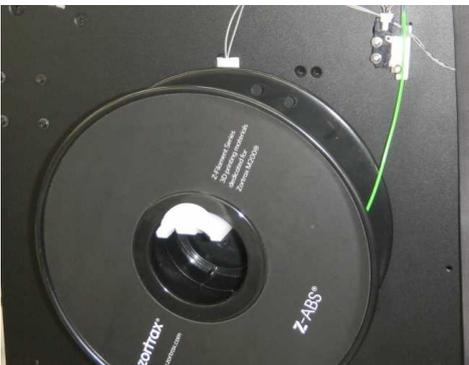
7-2 電源を入れ、フィラメントを抜いてサーボを動作させては、ボタンを押せるようになるまで微調整ネジを緩めていきます。
