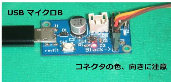
3-1-2 テスト用ボタンを押しサーボが動作する事を確認します。
