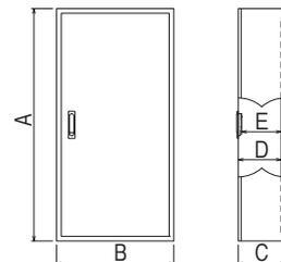
**収納安定器400W以下の場合** (ドア下有効フカサ (D) 180mm ハンドル下有効フカサ (E) 160mm)
