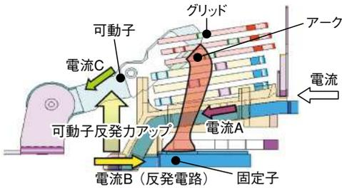
固定子の下側導体(可動子の反発電路)を延長することで、従来のISTAC構造よりも高速な可動子の開極を実現。
