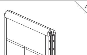
上辺フレームを元に戻し、ビスを取り付けてセット完了です。
