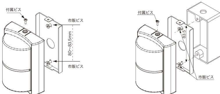
ご注意：本体は防水構造になっていますが、壁面のコード引き込み部の防水処理は行ってください。
