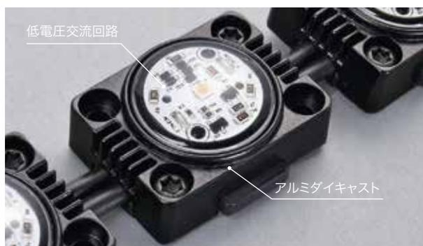
信頼性に優れたAC24V回路や、アルミダイキャストボディを採用。樹脂部分にはUL94、UL746Gといった難燃性、耐候性の規格をクリアした素材を使用しています。
