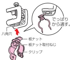
①板ナット取付ねじを緩め、八角穴に板ナットをはめ込み、ねじ締め固定します。
