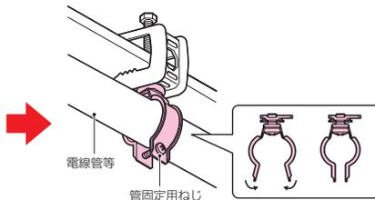
②クリップ内に電線管を入れ、付属の管固定用ねじで固定します。
