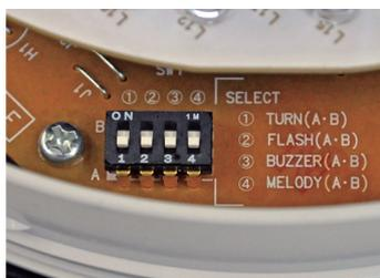
内部動作切替スイッチ (電子音出力タイプ)
