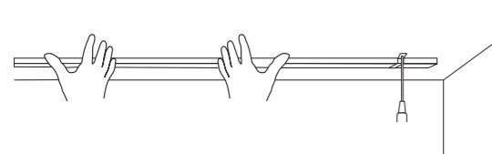
天井に取り付ける時など、灯具を持ち上げる際は、端の1箇所のみを持ち上げたり、1箇所のみを固定して垂らすなど、器具が極端に反る状態は避けてください。
